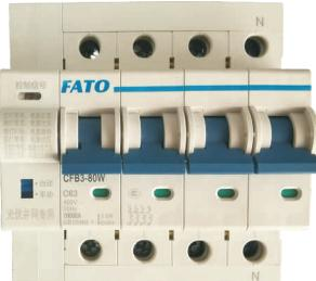
CFB3-80WGQ自恢复式过欠压保护断路器是最新研制开发的一款整体式结构的微型断路器，该产品采用电动操作机构的原理，集过载、短路、过压和欠压多重保护于一体，并能在过、欠压故障消除后自动恢复合闸。安全可靠，使用方便。
